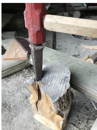
ナタで割れない丸太をクサビとハンマーで割る技法習得
